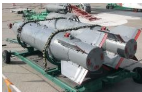
تصویر ۹-۳ - ۴ باله ثابت انتهایی بمب کاب-۱۵۰۰ ال
