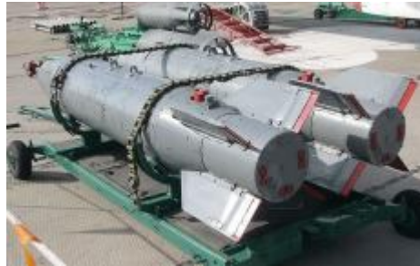
تصویر ۳-۹ - ۴ باله ثابت انتهایی بمب
